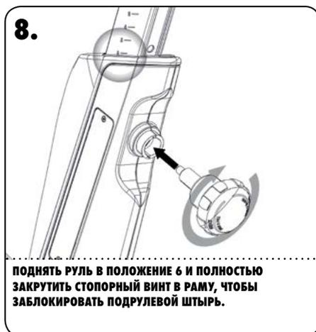
**ПОДНЯТЬ РУЛЬ В ПОЛОЖЕНИЕ 6 И ПОЛНОСТЬЮ ЗАКРУТИТЬ СТОПОРНЫЙ ВИНТ В РАМУ, ЧТОБЫ ЗАБЛОКИРОВАТЬ ПОДРУЛЕВОЙ ШТЫРЬ.**
