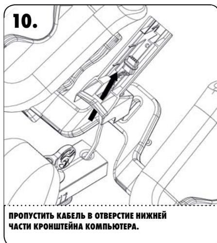
**ПРОПУСТИТЬ КАБЕЛЬ В ОТВЕРСТИЕ НИЖНЕЙ ЧАСТИ КРОНШТЕЙНА КОМПЬЮТЕРА.**
