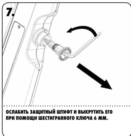
**ОСЛАБИТЬ ЗАЩИТНЫЙ ШТИФТ И ВЫКРУТИТЬ ЕГО ПРИ ПОМОЩИ ШЕСТИГРАННОГО КЛЮЧА 6 ММ.**
